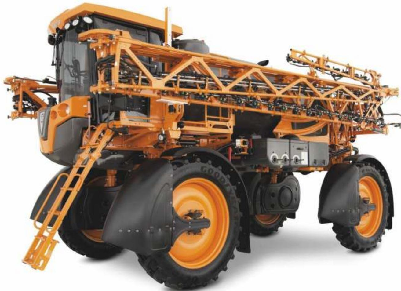
**Клиренс опрыскивателя регулируется** и его можно быстро выставить на высоту 1,55 м или 1,75 м.
