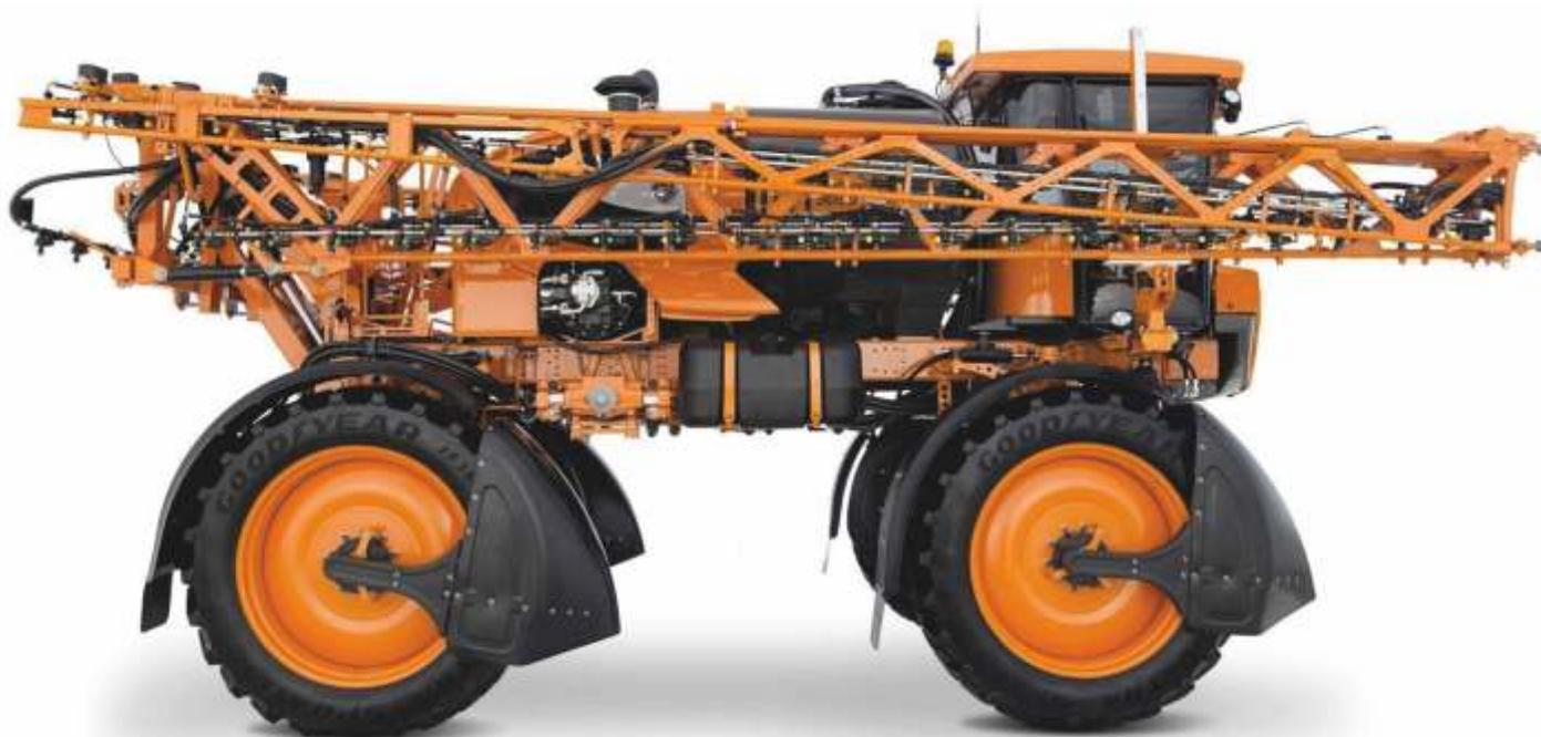
**Клиренс опрыскивателя регулируется** и его можно быстро выставить на высоту 1,55 м или 1,75 м.
