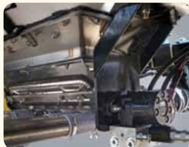
■ Гидромотор плавного регулирования нормы высева (опция).
