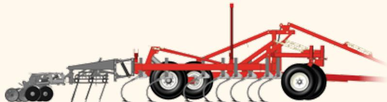
Гибридные сеялки серии 580Н представляют собой уникальное сочетание культиватора с дисковой сеялкой. За один проход агрегат 580Н подрабатывает почву, уничтожает сорняки и вносит семена с высокой точностью заделки по глубине.
